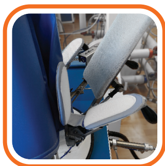
Fotocellula per regolazione automatica posizionamento fondo capi. Il corpo manichino raggiunge un'altezza molto elevata per permettere di stirare anche capi particolarmente lunghi H. 1800. Photocell for automatic adjustment and positioning of garments. The body of the dummy reaches a very high height to allow even particularly long items to be ironed H.1800.
