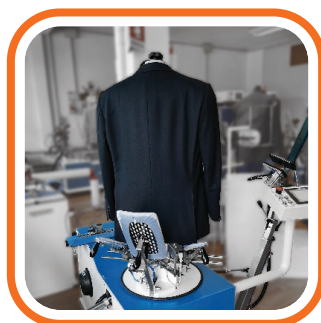
Rotazione del manichino di 270° per agevolare il posizionamento del capo. 270 ° rotation of the dummy to facilitate the positioning of the garment.
