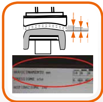
Sfumatura regolabile. Adjustable pressure.
