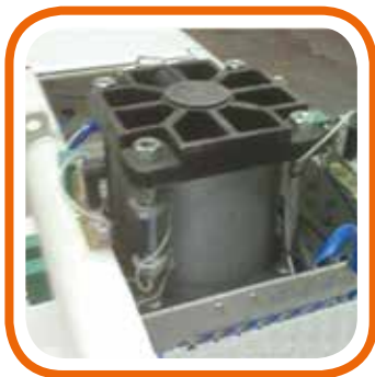
Grande cilindro di pressatura = ciclo veloce Big pressing cylinder = fast cycle
