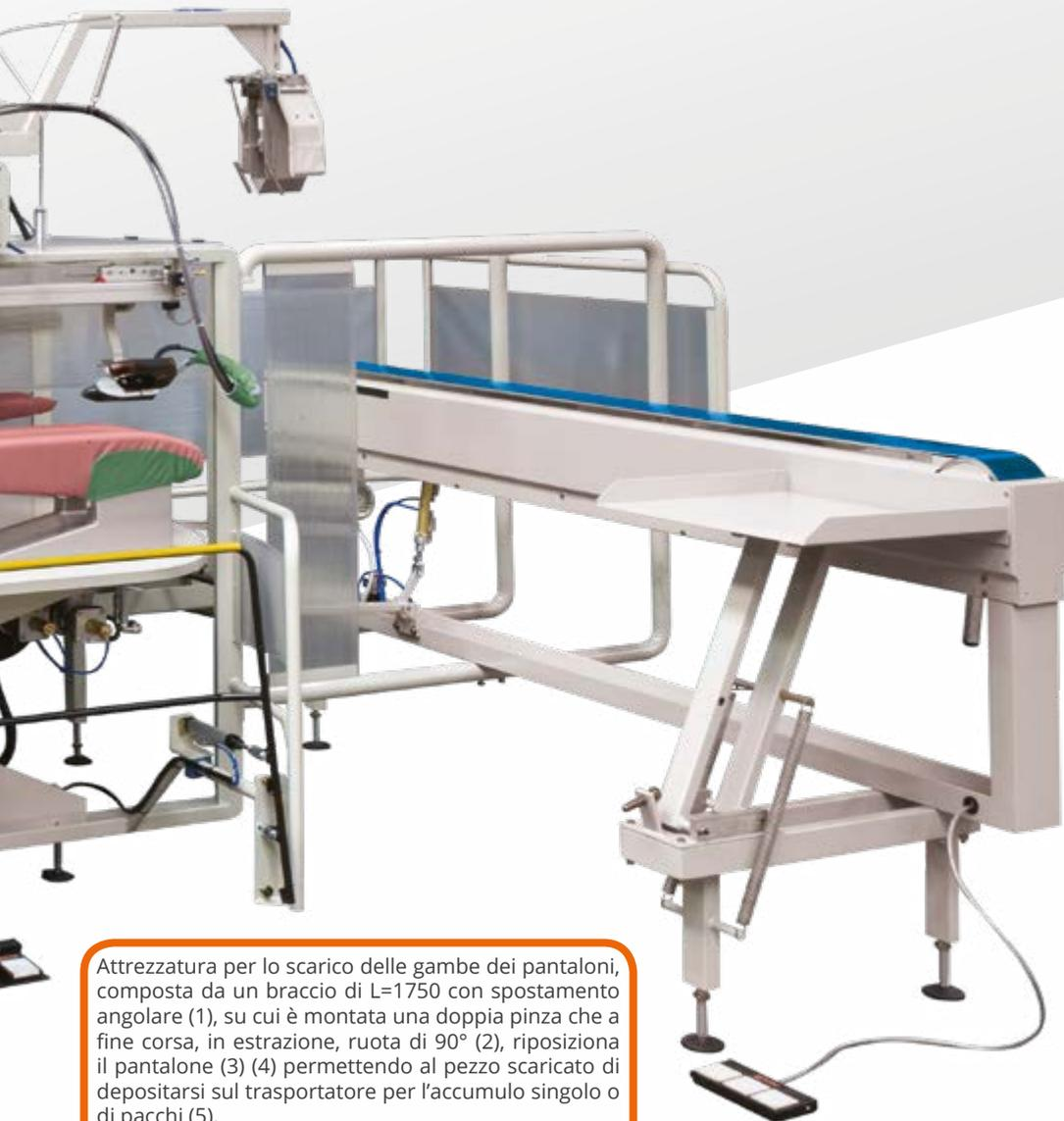
Attrezzatura per lo scarico delle gambe dei pantaloni, composta da un braccio di L=1750 con spostamento angolare (1), su cui è montata una doppia pinza che a fine corsa, in estrazione, ruota di 90° (2), riposiziona il pantalone (3) (4) permettendo al pezzo scaricato di depositarsi sul trasportatore per l'accumulo singolo o di pacchi (5).
