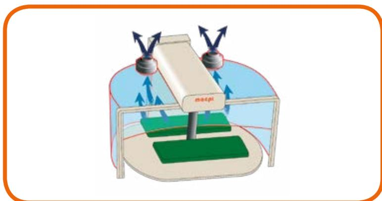
Di serie i caroselli macpi montano un sistema di cappe aspiranti che ha la funzione di eliminare il vapore in eccesso, mantenendo l'ambiente di lavoro più fresco senza aggiunta di costi per la climatizzazione.
