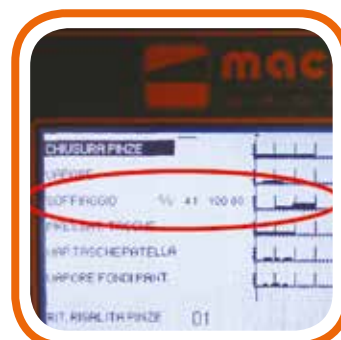
Regolazione quantità soffiaggio con inverter
